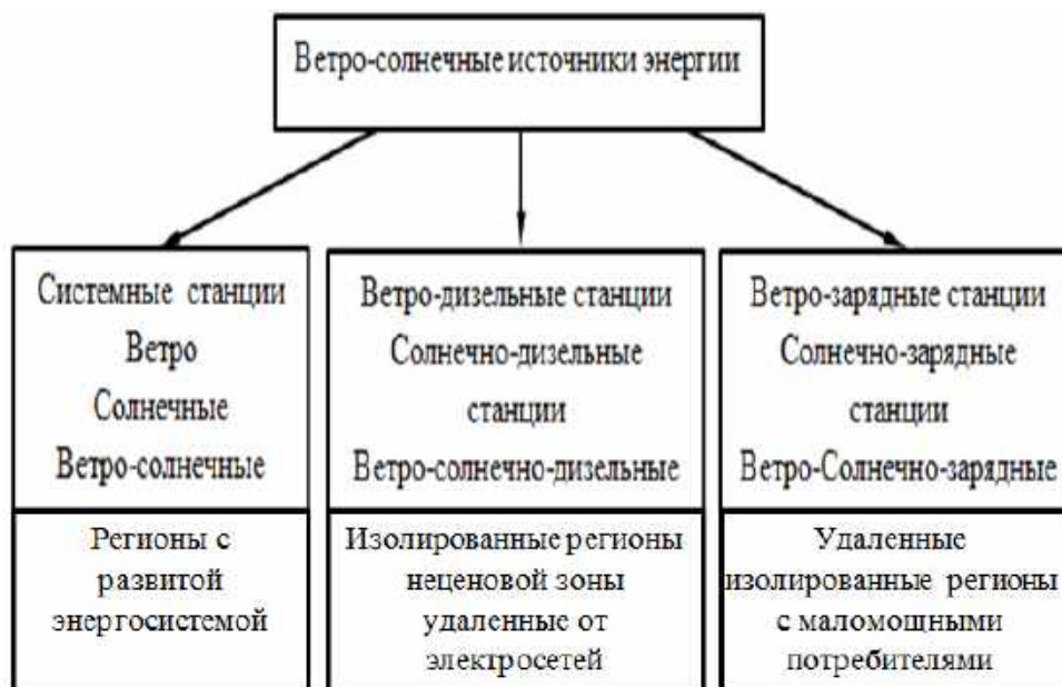
Рис.1 Классификация электрогенерирующих ветро-солнечных станций.
