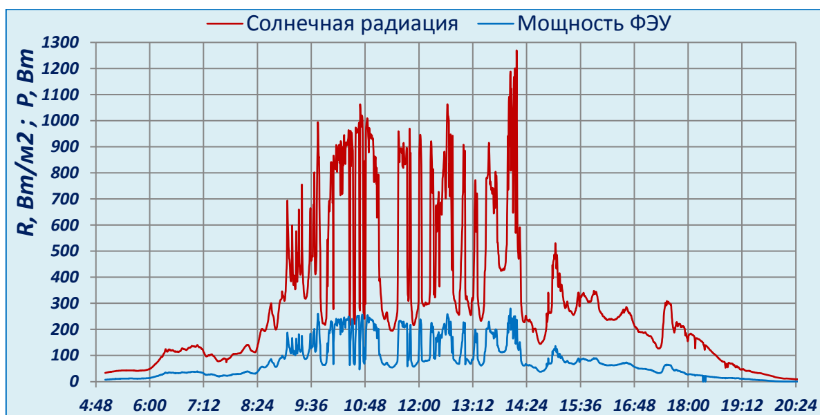
Рис. 1. Мгновенные значения солнечной радиации и мощности ФЭУ
