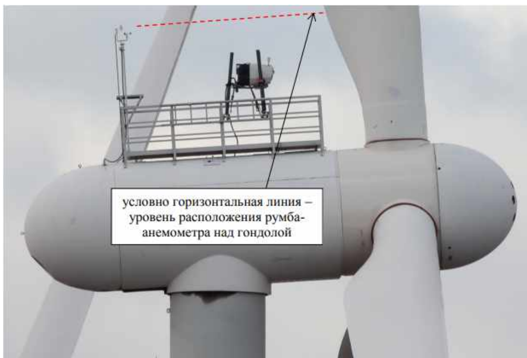
Рисунок 1. Расположение датчика скорости и направления ветра (анеморумбометра) на расстоянии 13 м от ротора и на высоте 3 м (данные приняты для моделирования)
