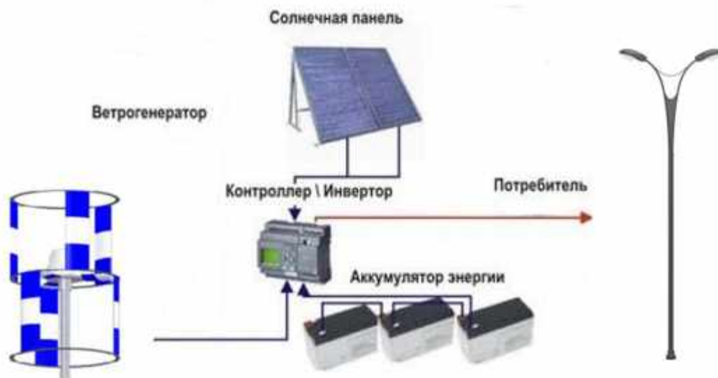
Рисунок 2. Пример схемы подключения ветро-солнечной установки
