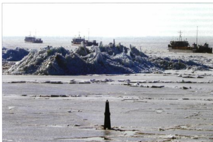
Рис. 4. В январе 2010 г. в морской части канала образовалась огромная стамуха высотой около 8 м, почти полностью перекрыв судовую ход
