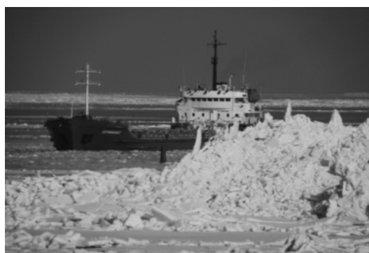
Рис. Танкер в зоне ВКСМК обходит стамуху возле зимнего буя («сигары»)
