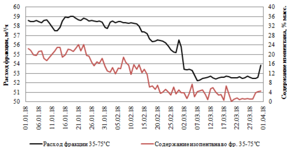
Рис. 2. Расход фракции 35-75°C на установку изомеризации пентан-гексановой фракции и содержание в ней изопентана
