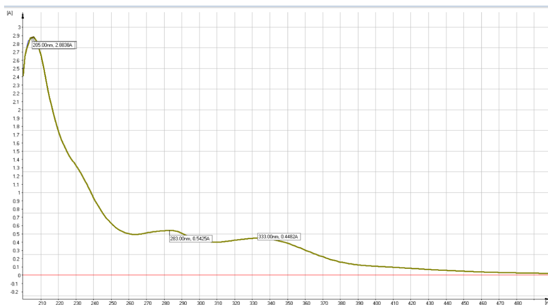
Рис. 2. УФ-спектр поглощения испытуемого спиртового раствора
